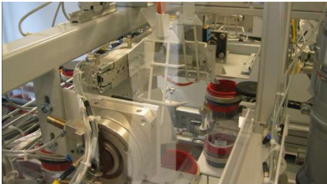
Robot pakujący indywidualne dawki leków do pojemników transportowych
